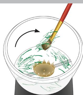
**B** Sweep with a clean, dry, soft paintbrush. / Balayer avec un pinceau propre, sec et doux. / Limpie con un pincel suave, seco y limpio. / Verwenden Sie einen sauberen, trockenen, weichen Pinsel zum Auskehren.
